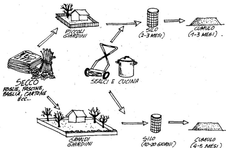
**Schema tipo per la gestione di un ciclo standard di compostaggio di 4-6 mesi con accumulo in silo e rete.**
